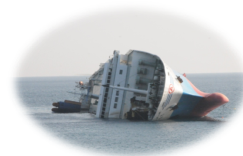
復原力喪失現象による大傾斜
