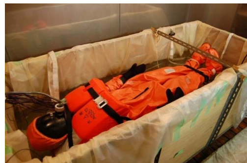
写真8 サーマルマネキンによる保温性試験
