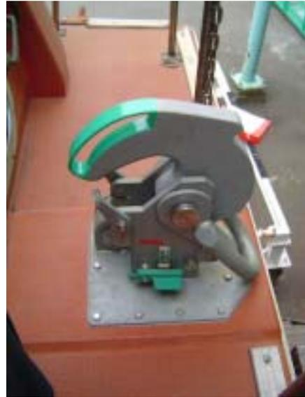
写真2 改良型離脱装置（離脱フック）
